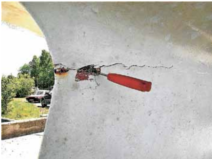
Omega 30A -84. Ett yttre bevis på en köl som inte sitter fast.
