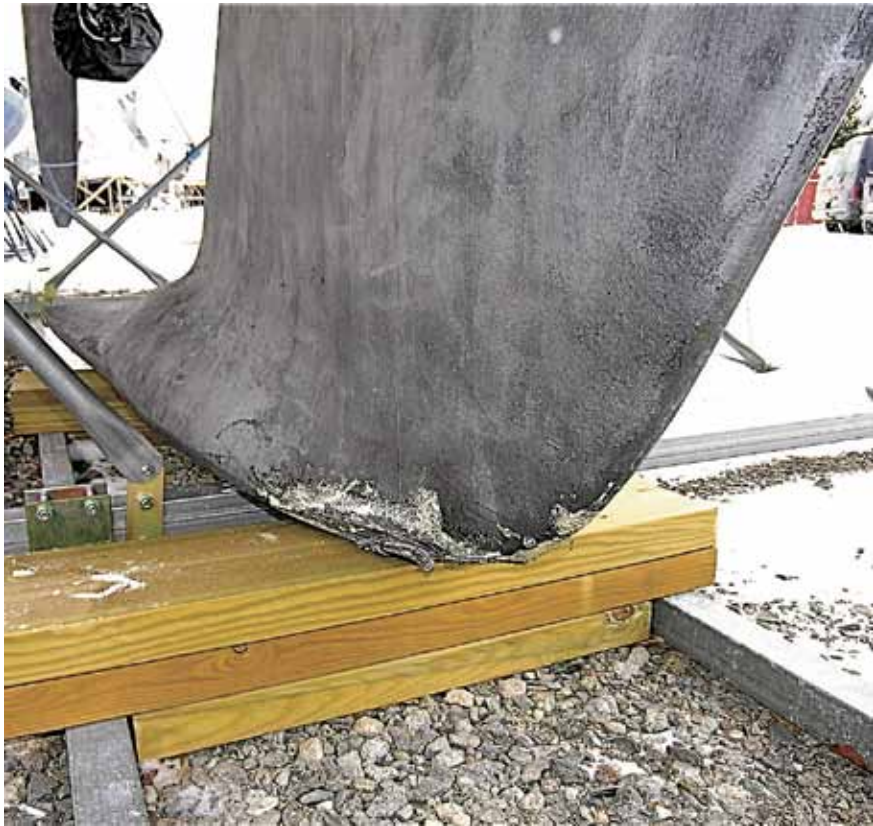
Maxi 38+ -98. Bilden visar en snedträff på styrbords framsida av kölen. Basinredet och pentrydelen akter om kölen styrbords sida helt lösa, läckande dieseltank, akterhyttens skott och dörrarm babords sida skeva samt akterstagets infästning lös.
