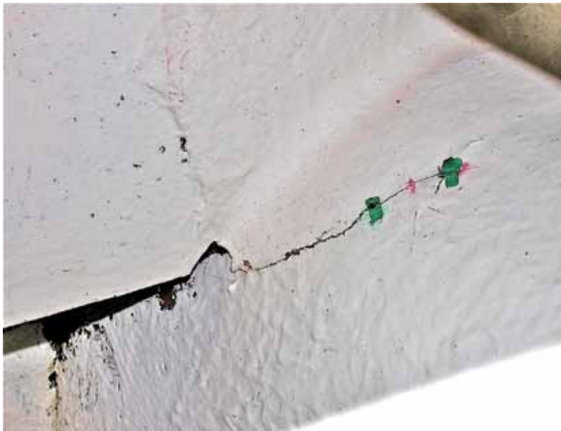
Omega 36 -90. En typisk ”svajkölskonstruktion” där båtbyggaren plastat fast några plywood-skivor som durkstöd. Tuschmärken visar på hur sprickan flyttar sig med åren.
