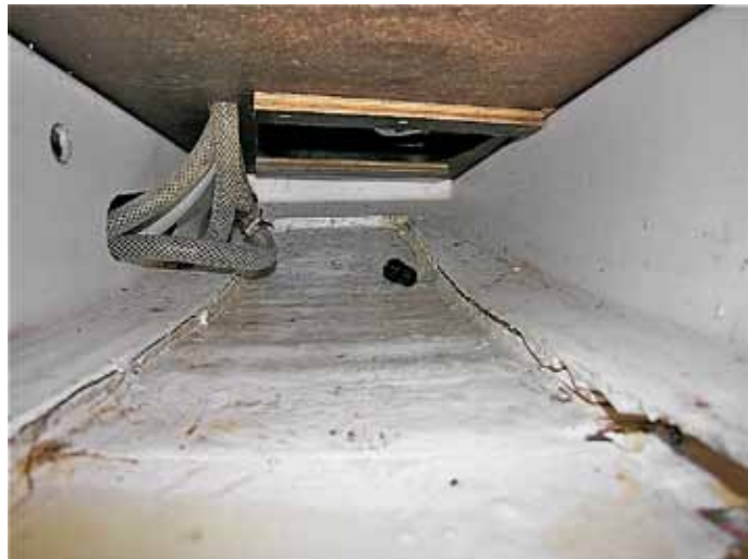
Bilden visar det helt loss-slitna basinredet från skrovet och de tre slangarna är för varmt och kallt sötvatten plus sjövattnet upp till pentryt ovanför.
