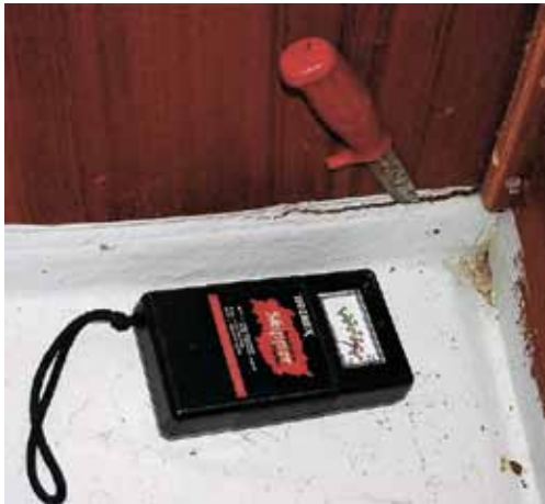
Diva 399 -91 Fart okänd. Troligen en rak träff framifrån. Bilden tagen i babords stuv i salongen. Huvudskottet har slitits loss från fastplastningen i botten ända bort till styrbords sida och fukt har trängt in i sandwichlaminatet.
