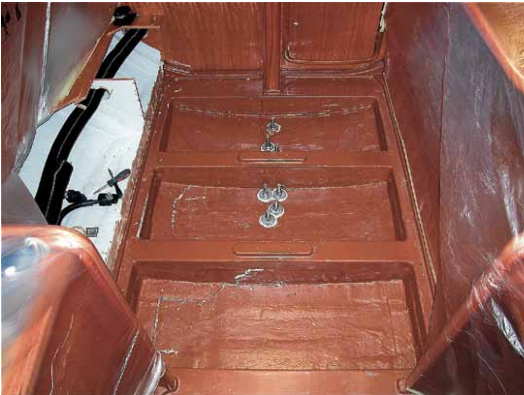
Bavaria 32 -02 Fart ca. 3 till 4 knop. En typisk snedträff på kölen från styrbord har skapat stora skador på babords botten och babords kojfront. Borrprover i balkar och i botten visade på så obegripligt låga värden som mellan 5 och 6 mm tjock laminat.
