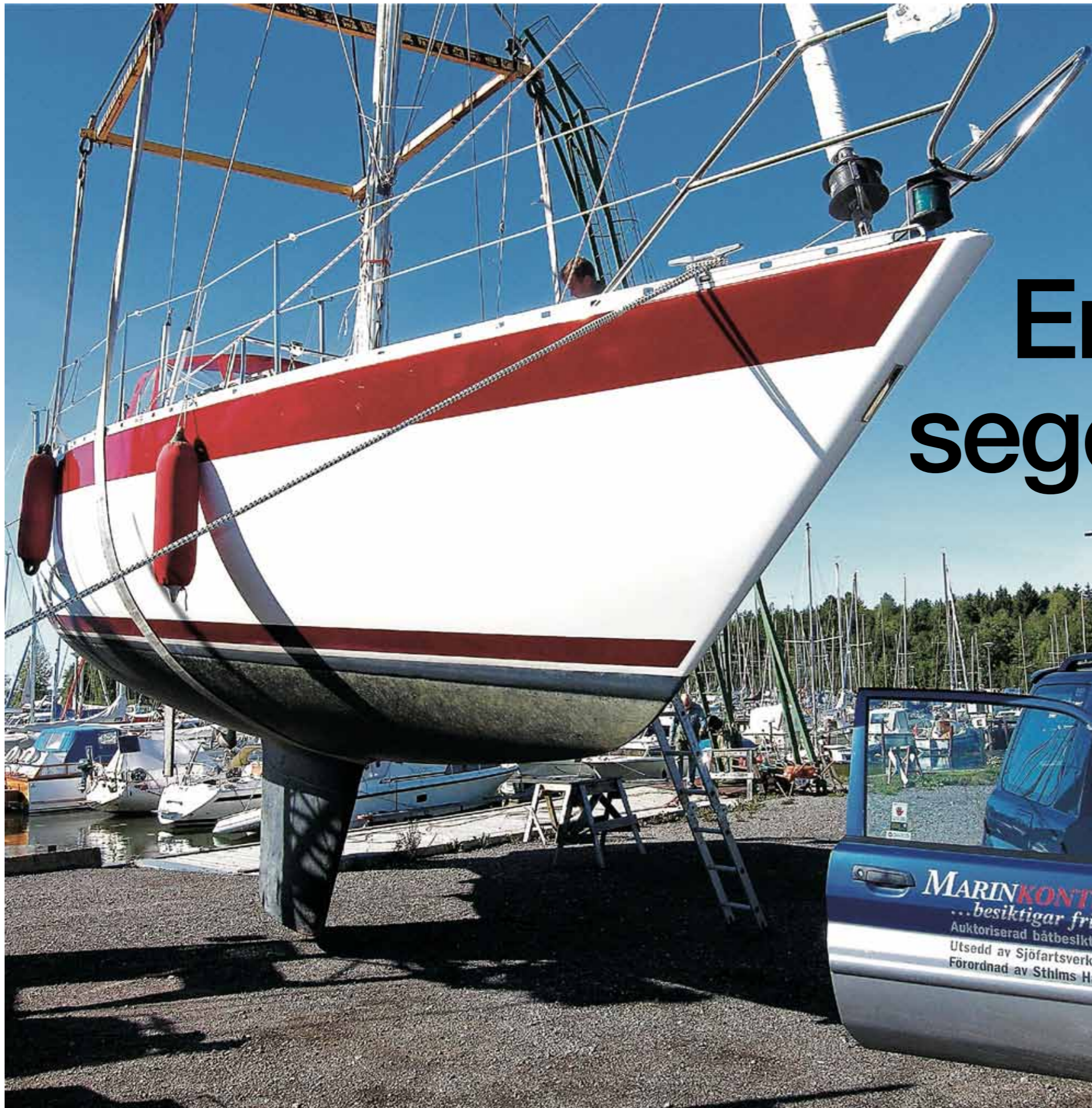
Scanmar 35 -83. En av flera svenska kölkonstruktioner utan kölbalkar och med inbyggd svajköl.
