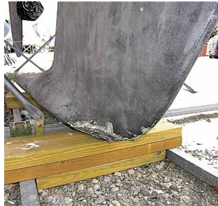
Omega 30A -84. Ett yttre bevis på en köl som inte sitter fast.
